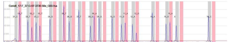
Exemple de courbe obtenue sur un ABI 3500 montrant la présence d'une interférence localisée au niveau du SNP1\_T et pouvant conduire à un étiquetage faussé chez les Hétérozygotes 01\_C. Cette courbe n'étant pas disponible pour le lot XP37.G.07, un spectre analogue obtenu avec le lot XP37.E.06 sur un séquenceur ABI 3500 est présenté pour exemple :
